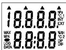
Přístroj se zapíná stiskem klávesy ON/OFF. Po zapnutí se na okamžik rozsvítí všechny znaky displeje pro jeho případnou kontrolu. Je-li klávesa ON/OFF při zapnutí přidržena stisknuta, svítí všechny znaky displeje až do uvolnění klávesy ON/OFF. Při běžném provozu se poté přístroj přepne do režimu měření a zobrazení hodnot měřených veličin.
