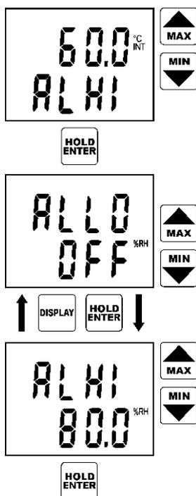
Nápis ALHI indikuje nastavovanou horní mez tétož alarmu. Postup nastavení hodnoty na požadovanou velikost je totožný s nastavením dolní meze alarmu. V případě potřeby je možno se vrátit zpět na nastavení dolní meze tétož alarmu klávesou DISPLAY. Stiskem klávesy ENTER je nastavená hodnota horní meze potvrzena.
