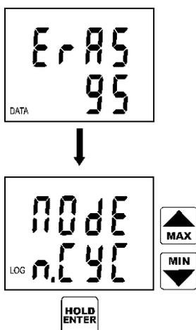
Tím je spuštěna procedura mazání, její průběh je indikován na displeji průběžným zobrazením procentuální hodnoty velikosti už vymazané paměti (číslíci 0 až 100).
