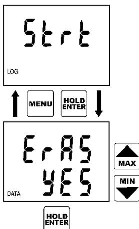
Je-li potřeba před spuštěním záznamu smazat paměť, je nutno nejprve zvolit z menu položku START záznamu (symbol Strt) a potvrdit ji klávesou ENTER. Upozornění: je-li indikována slabá baterie, nelze záznam spustit a tedy ani mazat paměť
